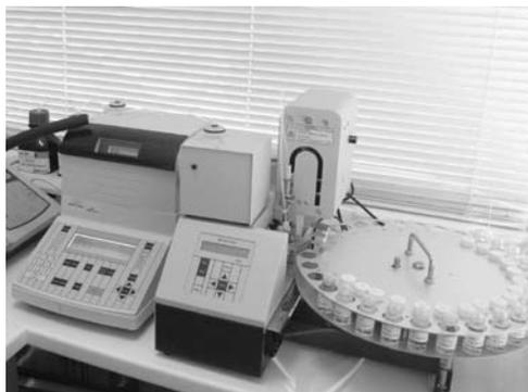
La nouvelle chaîne de mesure comprend un réfractomètre DR40 relié à une unité d'échantillonnage SC30, une pompe externe (Power Purge Unit) et un colorimètre
